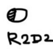
Для каждой камеры желательно обозначить угол раскрытия луча -- показывать, что «видит» камера. Луч камеры замыкать не нужно. Замкнутый луч означает точку фокусировки и рисуется только если есть задача показать это на схеме.
